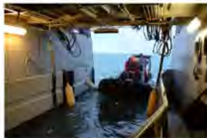
Un Hurricane entrant dans le radier du Pluvier
